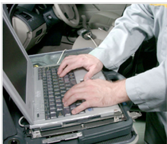
Figure 86. La régénération à l'aide de l'outil de diagnostic.
